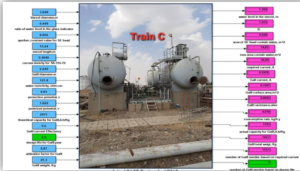
Fig. (8): Matlab simulation of Actual SACP design for desalter
